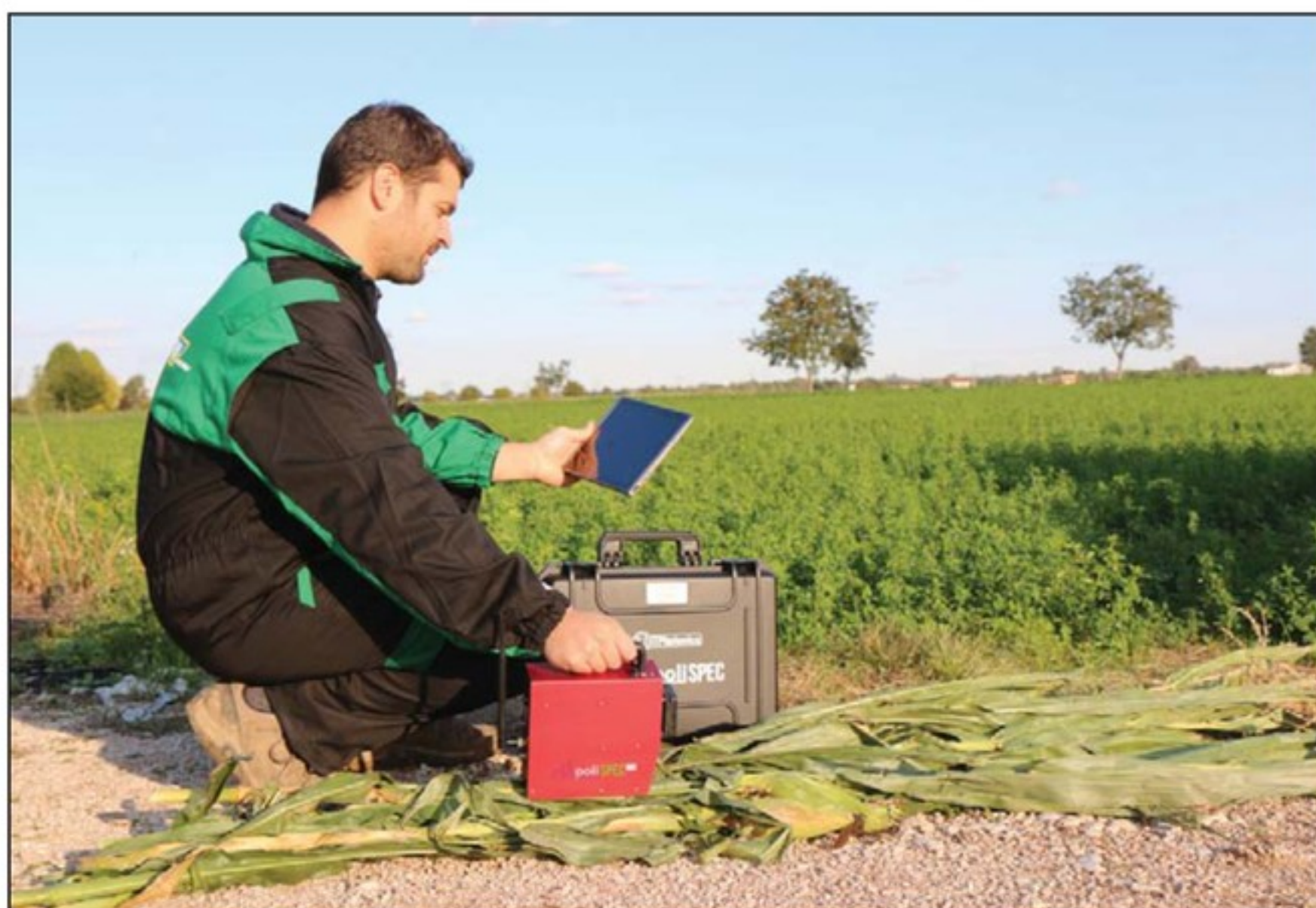
Figura 1.4 – Analisi in campo con tecnologia Nir delle caratteristiche qualitative del mais.
