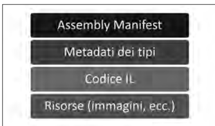
Figura 1.7 - Formato e contenuto di un assembly .NET.
